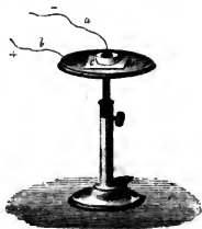
Fig. 131. — Décomposition de la potasse par le courant électrique.
